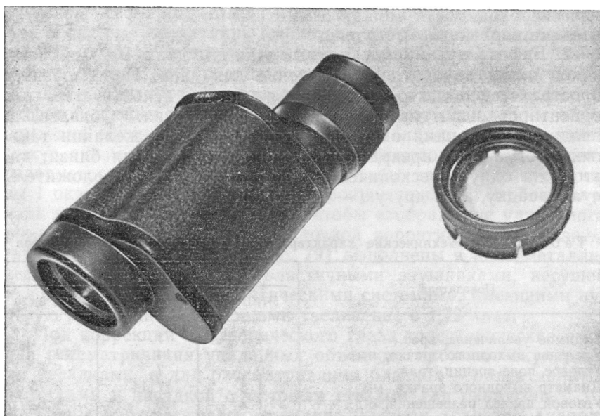
Рис. 82. Призменный светосильный монокуляр МПГ 7×50.
